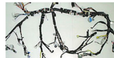
不含鹵素皮材電線 (含鹵素系塑膠在燃燒時會產生戴奧辛)
